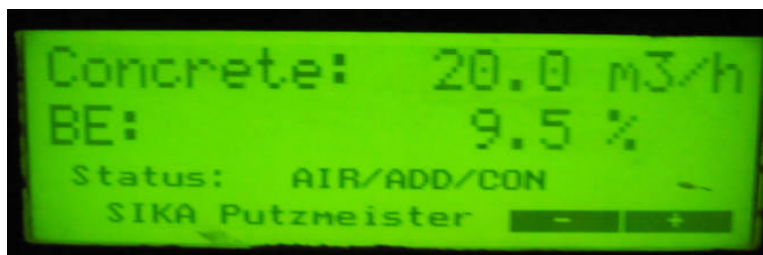
9. ábra Lőttbeton szivattyú kijelzője
