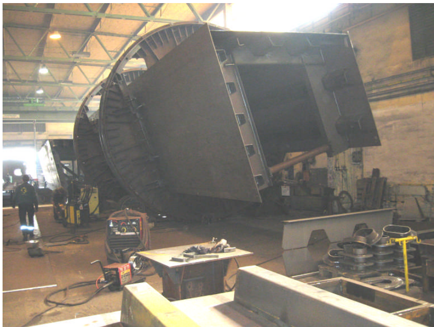
10. kép "C" elem hegesztése a forgatókészülékben
