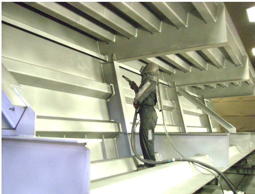
11. kép Szemcseszórás korrózióvédelem előtt
