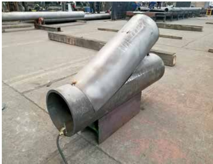
71. kép - Tisza híd cső főtartó csomópont
