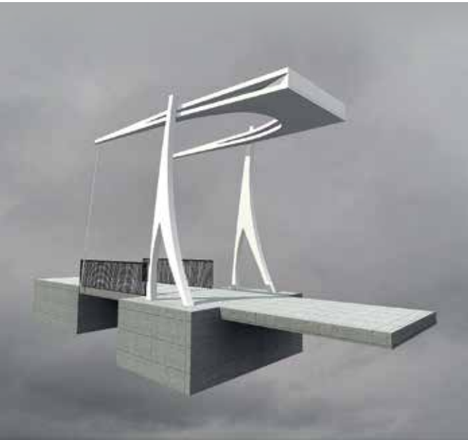
8. kép: Nyitható hídszerkezet
