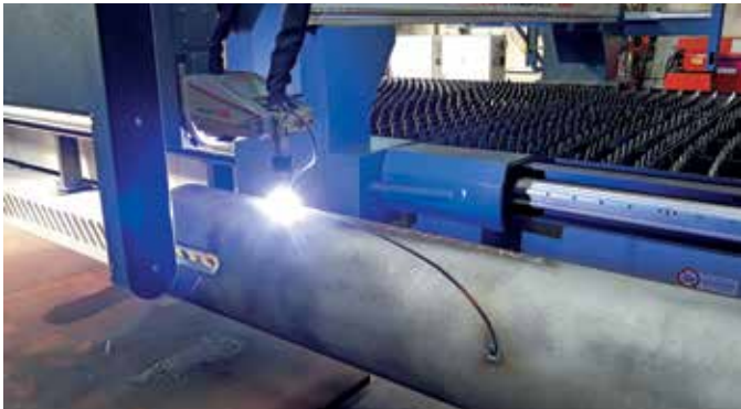
52. kép – Munkában az új 3D plazmavágó berendezés
