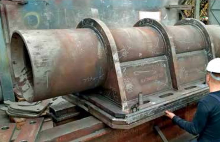
53. kép – A „hurkatöltő” támasz (Eger-patak- és Szomorka-patak híd támaszelem)
