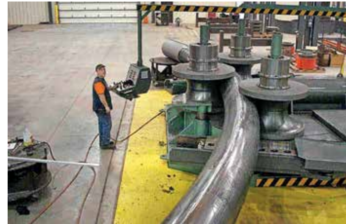
50. kép - Eger-patak- és Szomorka-patak híd cső főtartóinak hajlítása
