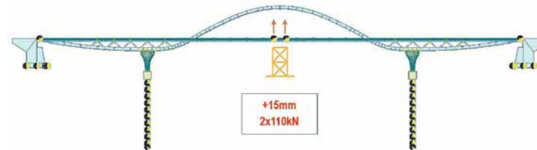
30. ábra: Rudak feszítése a merevítőtartó megemelésével
